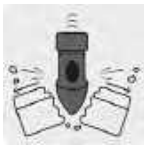
Fată de demolare care împrăștie materialul pe laturi
