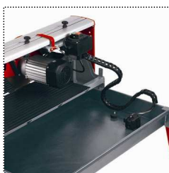
Jgeab de apa cu pompa de racier integrate pentru alimentarea cu apa si canal de scurgere
