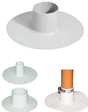
Colierele din PVC au fost concepute sa realizeze racordarea membranelor din PVC cu eventualele tevi de scurgere care le strapung, asigurand totodata si etansarea perfecta. Colierele au o flansa neteda, pentru a imbunatati aderenca la membranele sintetice. Ele sunt realizate din materiale care au proprietati elastice foarte bune, conferindu-le o etansare perfecta de durata. Formele conice permit montarea tevilor in interiorul lor.
