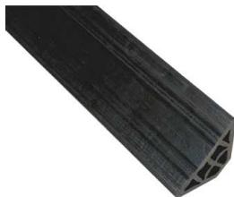
Scafa in BIT este folosita pentru a elibera unghiul de 90°, in timpul punerii in opera a membrane bituminoase, intre planurile orizontale si peretii verticali. Este recomandat ca inainte de punerea in opera a membranei sa se curete cu atentie muchiile. Scafa este asezata de-alungul perimetrlui si este compatibila cu membranele bituminoase. Aproape de muchii si de surgeri coltarul trebuie tatait la 45°.
