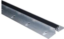
Profilul "TP" rost din aluminiu, este realizat cu un profil din aluminiu, cu gauri pe partea de ancorare, cu garnituri elastice din PVC, rezistente la agenti atmosferici, acizi sau uleiuri. Garniturile elastic sunt de asemenea interschimbabile cu profilul, pot fi disponibile la lungimi de 40 lm.
