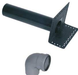
Scurgerile de colt SPEIER, din TPE au fost concepute sa rezolve problema conectarii sistemelor hidroizolante cu conductele de eliminarea apelor pluviale de pe acoperisuri, care sunt aproape de pereti. Scurgerile de colt au o flansa cu nervuri pentru a imbunatati aderenta la membrane bituminoase. Scurgerile de colt au o flansa cu gauri, pentru a imbunatati fixarea mecanica la betonul armat si la pereti.
