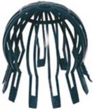
Scurgerile de camp TPE sunt folosite pentru conectarea sistemelor hidroizolante cu conductele de eliminarea apelor pluviale de pe acoperisuri. Forma usor conica permite instalarea rapida si simpla in conductele de eliminarea apelor pluviale de pe acoperisuri. Partea cilindrica superioara are o serie de cavitati, care asigura fixarea etansa a protectiilor de frunze si pietris.
