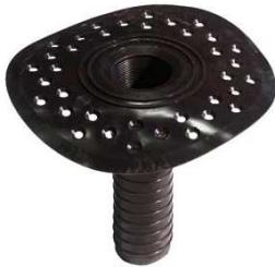
Scurgerile de camp din EPDM sunt folosite pentru conectarea sistemelor hidroizolante cu conductele de eliminarea apelor pluviale de pe acoperisuri. Forma usor conica permite instalarea rapida si simpla in conductele de eliminarea apelor pluviale de pe acoperisuri.
