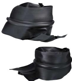
Profilele au o parte centrala, care actioneaza ca o imbinare si doua laturi canelate pe fiecare parte, pentru a asigura o adezivitate perfecta a imbinarii pe hidroizolatiile din membrane bituminoase sau membrane sintetice din PVC. Versiunea GDO are un bulb cu rol de tripla protectie, pe cand versiunea GDL are un bulb care confera o dubla protectie.
