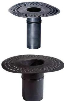
Scurgerile de camp din BIT sunt folosite pentru conectarea sistemelor hidroizolante cu conductele de eliminarea apelor pluviale de pe acoperisuri. Forma usor conica permite instalarea rapida si simpla in conductele de eliminarea apelor pluviale de pe acoperisuri. Scurgerile de camp au o flansa cu nervuri pentru a imbunatati aderența la membrane bituminoase si are doua inele de etansare pe partea cilindrica, care au rol de etansare intre teava scurgerii si scurgerea pluviala.
