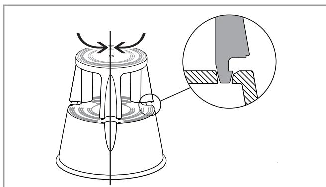
Alignez la partie supérieure sur la partie inférieure, de sorte que les crochets des pieds de la partie supérieure atteignent les trous de la partie inférieure.
