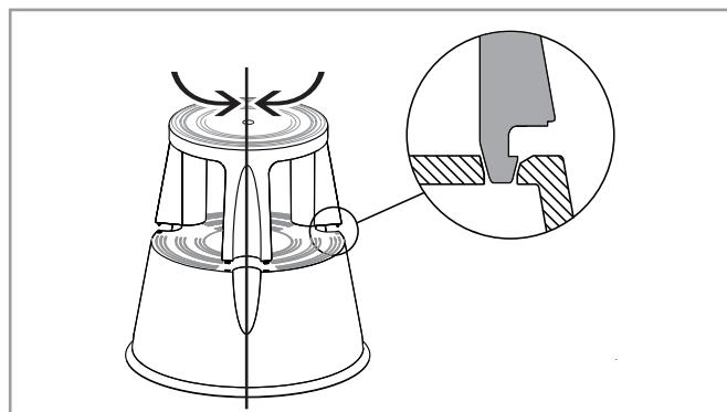
Allineare la parte superiore su quella inferiore, in modo che i ganci delle gambe della parte superiore si inseriscano nei fori della parte inferiore.
