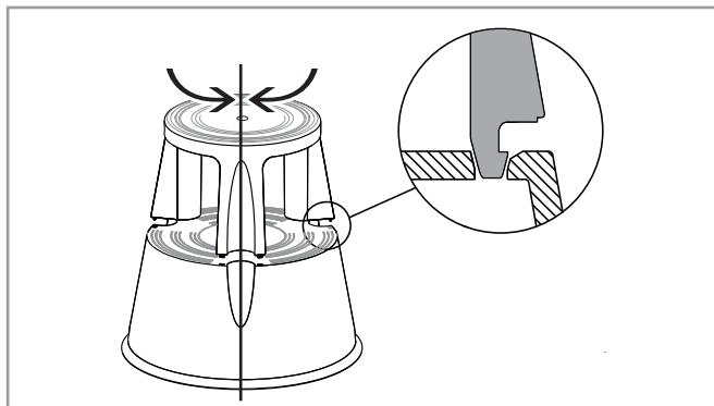
Rikta in den övre delen över den nedre delen, så att krokarna på överdelens ben når in i hålen på den nedre delen.
