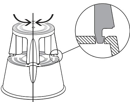
Das Oberteil so über dem Unterteil ausrichten, dass die Haken am Oberteil in die Löcher im Unterteil greifen.
