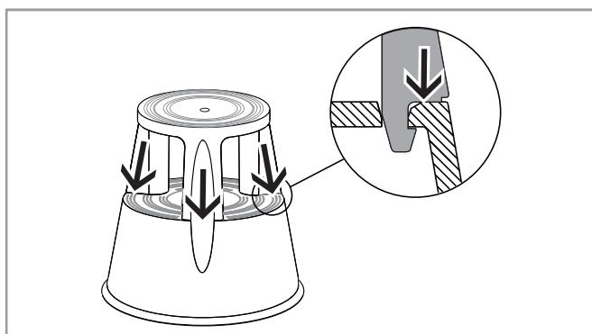
Pressa fast den övre delen på den nedre delen tills krokarna på alla tre ben klickar på plats. Se till att det inte finns något mellanrum mellan benen och den nedre delen.
