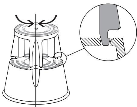
Zarovnejte horní část přes dolní část tak, aby háčky na nožkách horní části zapadly do otvorů v dolní části.
