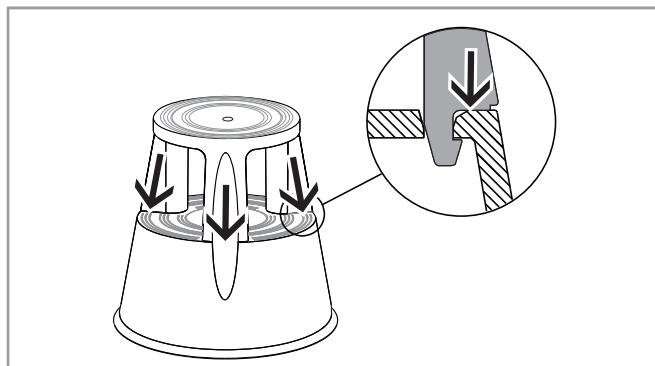
Appuyez la partie supérieure sur la partie inférieure jusqu'à ce que les crochets des trois pieds s'enclenchent. Assurez-vous qu'il n'y a aucun espace entre les pieds et la partie inférieure.
