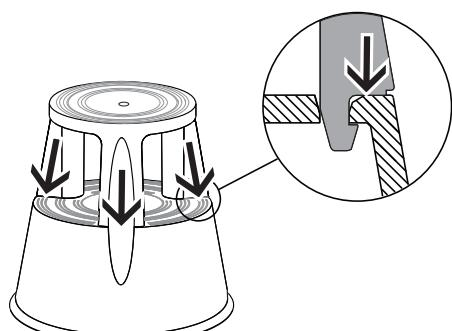
Apăsați partea superioară pe partea inferioară până când cârligele tuturor celor trei picioare se fixează în poziție. Asigurați-vă că între picioare și partea inferioară nu rămâne niciun spațiu.
