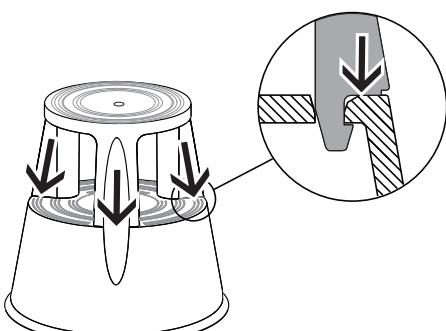
Das Oberteil auf das Unterteil drücken, bis die Haken an allen drei Beinen im Unterteil einrasten. Danach darf kein Spalt mehr zwischen den Beinen und dem Unterteil zu sehen sein.
