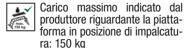
Carico massimo indicato dal produttore riguardante la piattaforma in posizione di impalcatura: 150 kg
