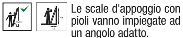
Le scale d'appoggio con pioli vanno impiegate ad un angolo adatto.
