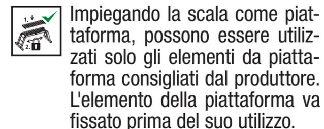
Impiegando la scala come piattaforma, possono essere utilizzati solo gli elementi da piattaforma consigliati dal produttore. L'elemento della piattaforma va fissato prima del suo utilizzo.
