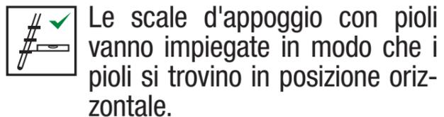
Le scale d'appoggio con pioli vanno impiegate in modo che i pioli si trovino in posizione orizzontale.
