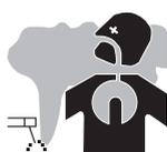
Beim Plasmaschneiden entstehen Rauchgase bzw. toxische Dämpfe, die zu Sauerstoffmangel in der Atemluft führen können. Sorgen Sie daher immer für ausreichend Frischluftzufuhr, technische Belüftung, oder ein zugelassenes Atemgerät. Prüfen Sie, dass die Absaugung ausreichend stark ist und den aktuellen Sicherheitsstandards entspricht.
