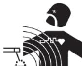
Elektrischer Strom, der durch einen Leiter fließt, erzeugt lokal elektrische und magnetische Felder (EMF). Der Schweißstrom erzeugt ein elektromagnetisches Feld um den Schweißkreis und die Schweißausrüstung herum.
