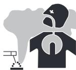
Beim Schweißen entstehen Rauchgase bzw. toxische Dämpfen. Sorgen Sie daher immer für ausreichende Frischluftzufuhr, technische Belüftung oder ein zugelassenes Atemgerät.
