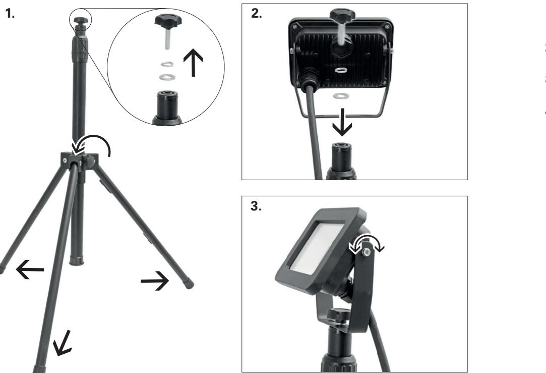
1. Sprid ut basen **8** öppna och fäst den på önskad höjd med fästspröven **3**. Ta bort fästspröven **1** och brickorna från stativet **10**.
