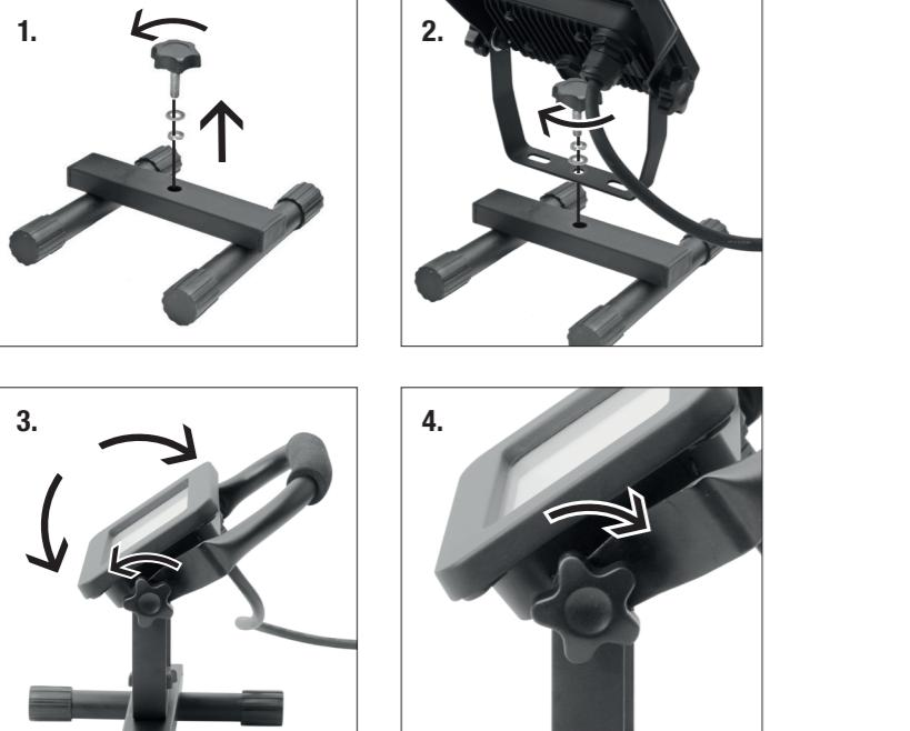
1. Skruva bort fästsprögen **5** och brickan från stativet till armaturen **4**.
