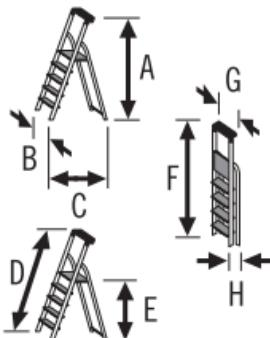
Габаритные размеры в установленном состоянии
