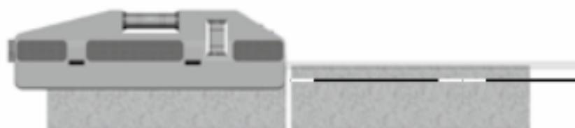
Для укладання стінової керамічної плитки слід встановити прилад за допомогою прижинового затиска, що розсувається за допомогою розташованих ззаду штифтів, на першу плитку. Сплюмувати лазерний промінь вздовж окрайку плитки паралельно поземниці. Це дозволить точно вирівнювати плитки поземницею.
