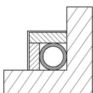
Țeavă de evacuare din oțel cu cameră dublă izolată cu material rezistent la 400 ° C. Eficiență optimă.
