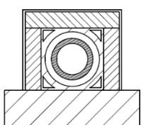
Țeavă de ardere refracțiară cu cameră dublă izolată și acoperire externă în beton ușor. Eficiență optimă.
