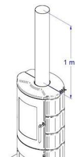
Tevile pentru cosul de evacuare trebuie să fie adecvate pentru sobele pe lemn și, prin urmare, trebuie să fie fabricate din oțel acoperit sau oțel inoxidabil, cu un diametru de 130 mm și prevăzute cu garnituri adecvate.
