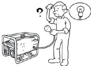
2. Este întrerupătorul în poziția "ON"?
