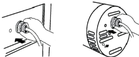
3. Porniți întrerupătorul sau împingeți în jos dispozitivul de protecție AC.
