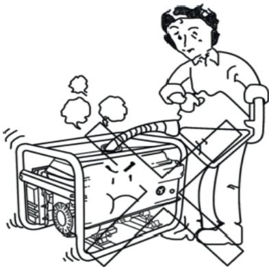
→ Nu uitați să opriți generatorul înainte de alimentarea cu combustibil.
