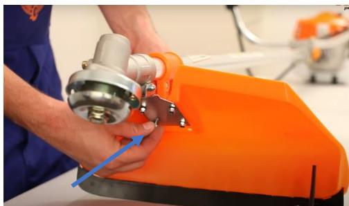
Montați protectia în punctele de fixare și strângeți ferm cele 4 șuruburi.
