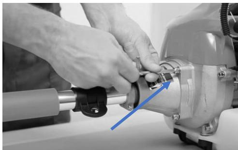
Se cuplează transmisia la unitatea motor folosind șuruburile și șaibele din dotare.
