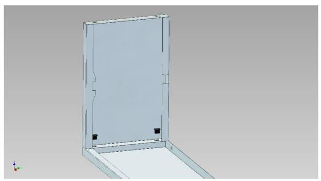
**BEVOR** Die Seitenwand mit Schloss montiert werden kann, muss das Schloss eingesetzt werden. Dafür lösen Sie die Schraube auf der Rückseite des Schlosses und entnehmen den Standardriegel, dieser wird nicht mehr benötigt. Das Schloss in das Riegelblech einsetzen und von hinten mit der Mutter befestigen. Nun montieren Sie den beiliegenden Riegel und testen ob er zur richtigen Seite schließt. Den Riegel mit der Unterlegscheibe und Schraube festziehen.
