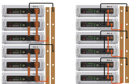
Figura 5-1 Diagrama schematică a conexiunii cablului de alimentare
