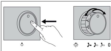
**Lumini** – Pentru a aprinde luminile, apăsați butonul rotativ și eliberați-l astfel încât acesta să iasă din locașul său.
