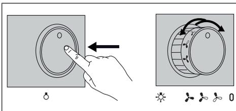
**Освещение** - Для включения освещения нажмите на ручку и отпустите, чтобы она поднялась.
