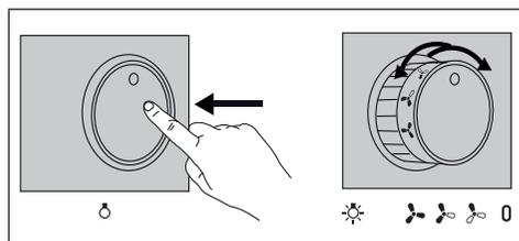
**Luces** - Para encender las luces, presione la perilla y suéltela para que salga de su alojamiento. Para apagar las luces, vuelva a presionar la perilla hacia adentro, colocándola en la posición de interruptor apagado.
