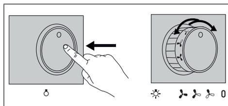
**Oświetlenie** - włącza się przez naciśnięcie pokrętki i zwolnienie go w taki sposób, aby wyszło na zewnątrz.
