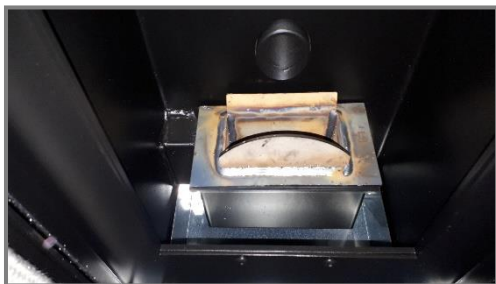
Exemplu de coș de ardere înfundat
