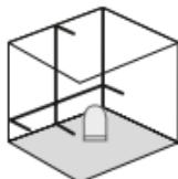
Die Transportsicherung lösen, Schiebeschalter (2) nach rechts schieben. Das Laserkreuz erscheint.
