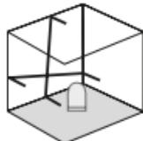
Ne pas dégager le blocage de transport, faire glisser l'interrupteur à coulisse (2) vers la gauche. Il est maintenant possible de travailler sur des plans inclinés. Il n'est pas possible d'effectuer un niveling horizontal ou vertical dans ce mode étant donné que les lignes laser ne s'orientent plus automatiquement. Les lignes laser clignotent en vert.
