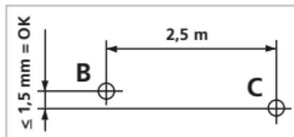
aan de wand markeren, laserkruis ca. 2,5 meter naar rechts draaien en punt C markeren. Controleer nu of de waterpaslijn van punt C op gelijke hoogte ligt met punt B - met een tolerantie van max.  $\pm 1,5 \text{ mm}$ . Dezelfde controle kunt u tevens naar links uitvoeren.
