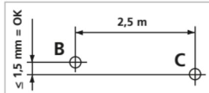
Сделайте отметку B на стене. Поворачивайте прибор, пока лазерный крест не сдвинется на 2,5 м вправо. Сделайте отметку C. Расстояние между горизонтальными линиями, проведенными через эти две точки, не должно превышать ± 1,5 мм. Повторите замеры, поворачивая прибор влево.
