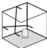
Přepravní pojistku neuvolňujte, posuvný vypínač (2) posuňte doleva. Laser zapněte tlačítkem ZAP/VYP. Nyní je možné zalícit šikmě roviny. V tomto režimu není možné provádět horizontální resp. vertikální nivelačci, protože linie laseru se již automaticky nevyrovnávají. Laserové linky blikají zeleně.
