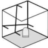
Não solte o bloqueador de transporte, deslize o interruptor de corrediça (2) para a esquerda. Ligue os lasers com o botão para ligar/desligar. A seguir podem ser traçados níveis inclinados. Neste modo não é possível nivelar horizontal e verticalmente, uma vez que as linhas de laser não se alinham automaticamente. A linha de laser piscam a verde.
