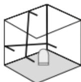
Transportsikringen skal ikke løsnes, skyv skyvebryteren (2) mot venstre. Laseren slås på med PÅ/AV-knappen. Nå kan instrumentet legges på skjeve flater. I denne modus kan det ikke nivelleres horisontalt eller vertikalt, da laserlinjene ikke innretter seg automatisk mer. Laserlinjene blinker grønt.
