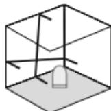
Älä löysää kuljetusvarmistinta, työnnä liukukytkin (2) vasemmalle. Kytke laser päälle ON/OFF-näppäimellä. Nyt voit mitata kaltevia pintoja. Tässä tilassa ei voida linjata vaaka- tai pystysuorassa, sillä laserlinjat eivät enää tasaudu automaattisesti. Vihreät laserviivat vilkkuvat.
