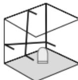
Під час транспортування не знімати блокуючий елемент, вимикач (2) перевести в ліве положення. Увімкнути лазер за допомогою кнопки УВІМК/ВІМК. Тепер можна будувати похилі площини. У цьому режимі не можна здійснити горизонтальне або вертикальне нівелювання, тому що лазерні лінії вже автоматично не вирівнюються. Блимають зелені лазерні лінії
