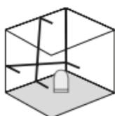
Ne oldja ki a szállítási biztosítót, és tolja a (2) tolókapcsolót balra. Kapcsolja be a lézereket a BE/KI nyomógommbal. Ekkor ferde síkok hozhatók létre. Ebben az üzemmódban nem végezhető vízszintes, ill. függőleges szintezés, mivel a lézervonalak beállítása már nem történik meg automatikusan. A lézervonalak zölden villognak.
