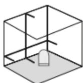
Otpustiti transportni zatvarač, klizni prekidač (2) gurnuti u desno. Pojavit će se laserski križ.
