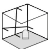
Prepravnú poistku neuvolnite, posuvný vypínač (2) posuňte doľava. Laser zapnite tlačidlom ZAP./VYP. Teraz môžu byť vytvorené šikmé roviny. V tomto režime nie je možná horizontálna, resp. vertikálna nivelácia, pretože laserové línie sa už automaticky nenasmerujú. Laserové čiar blikajú na zeleno.
