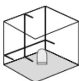
Uvoľnite prepravnú poistku, posuvný vypínač (2) posuňte doprava. Zobrazí sa laserový kríž.
