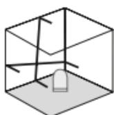
Ne otpuštati transportni zatvarač, klizni prekidač (2) gurnuti u lijevo. Odabrati i uključiti laser tipkom za odabir. Sada se mogu mjeriti kose ravnine. Ovaj način rada se ne može koristiti za obavljanje horizontalnog ili vertikalnog niveliranja jer se laserske linije više ne poravnavaju automatski. Laserske linije trepću zeleno.
