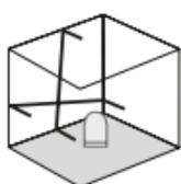
Nu slăbiți șuruburile pentru transport, poziționați comutatorul glisant (2) spre stânga. Laserul se operează prin tasta PORNIRE/OPRIRE. Acum se pot marca suprafețele înclinate. În acest mod nu se poate nivela în plan orizontal resp. vertical, pentru că razele laser liniare nu se mai ajustează automat. Liniile laser luminează verde intermitent.
