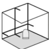
Sprostite transportno varovalo, drsno stikalo (2) potisnite v desno. Prikazal se bo laserski križec.
