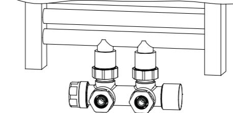
D Verbinden Sie die 3/4"-Seite des Adapters mit dem Ventilkörper wie in Abbildung 3
