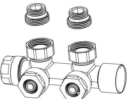
D Entfernen Sie den 1/2"\*\*3/4"-Adapter von der 3/4"-Mutter, wie Abbildung 1
