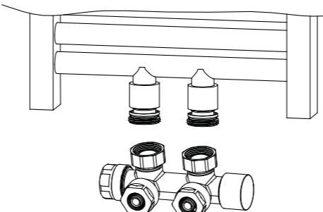
D Schrauben Sie den Adapter mit der 1/2" Seite in die Radiatorenanschlussrohre wie in Abbildung 2
