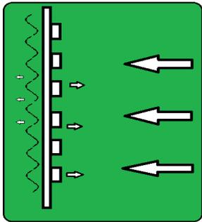
Pentru spatiile unde estetica dar si acustica este importanta, panourile pot fi montate pe rigle orizontale cu spatiu de aproximativ 60 cm intre ele, rigle cu dimensiunea de 20 mm grosime si 40 mm latime fixate cu dibluri in perete, in spatiul dintre rigle se va monta vata bazaltica de 20 mm grosime dupa care se fixeaza panourile cu holzsuruburi.
