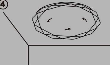
Montați înapoi capacul pe corpul de iluminat și fixați-l prin înșurubare în sensul orelor de ceasornic până la refuz
