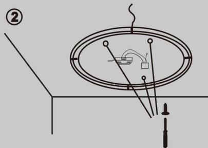
Găuriți orificiile, introduceți dibluri potrivite și montați corpul de iluminare
