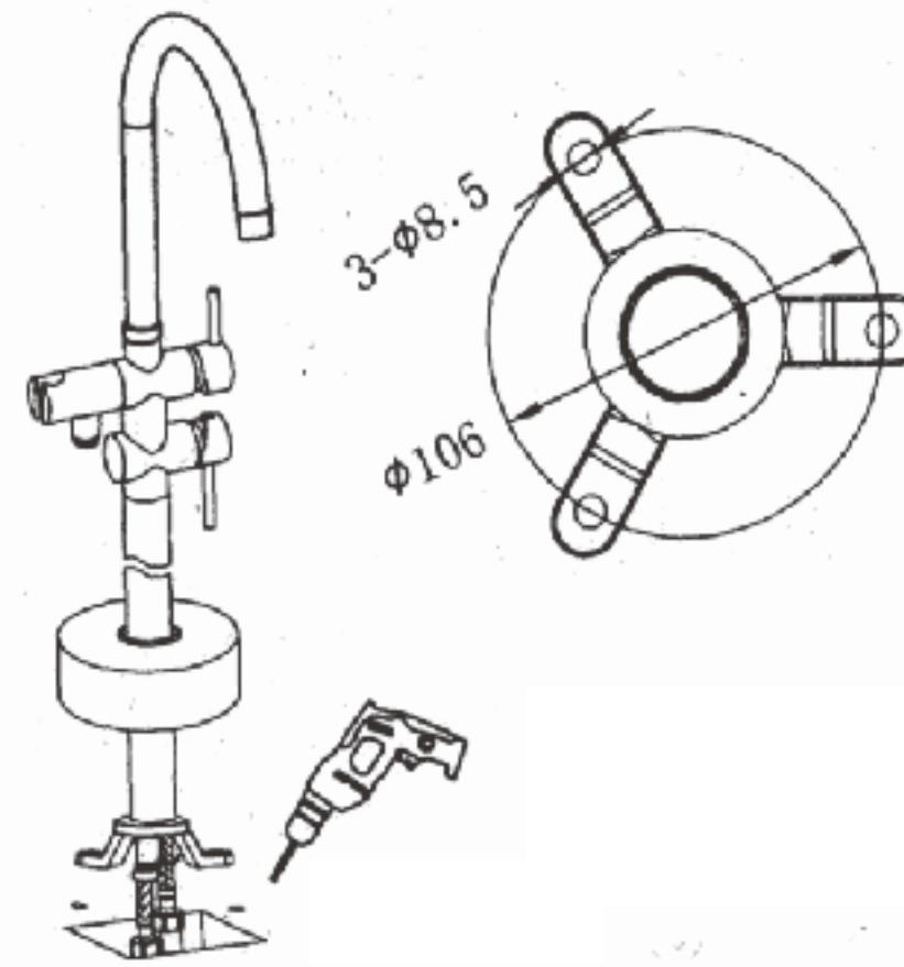
6. Pozitionati si fixati bateria in gaurile forate, cu ajutorul suruburilor cu diblu (8).
