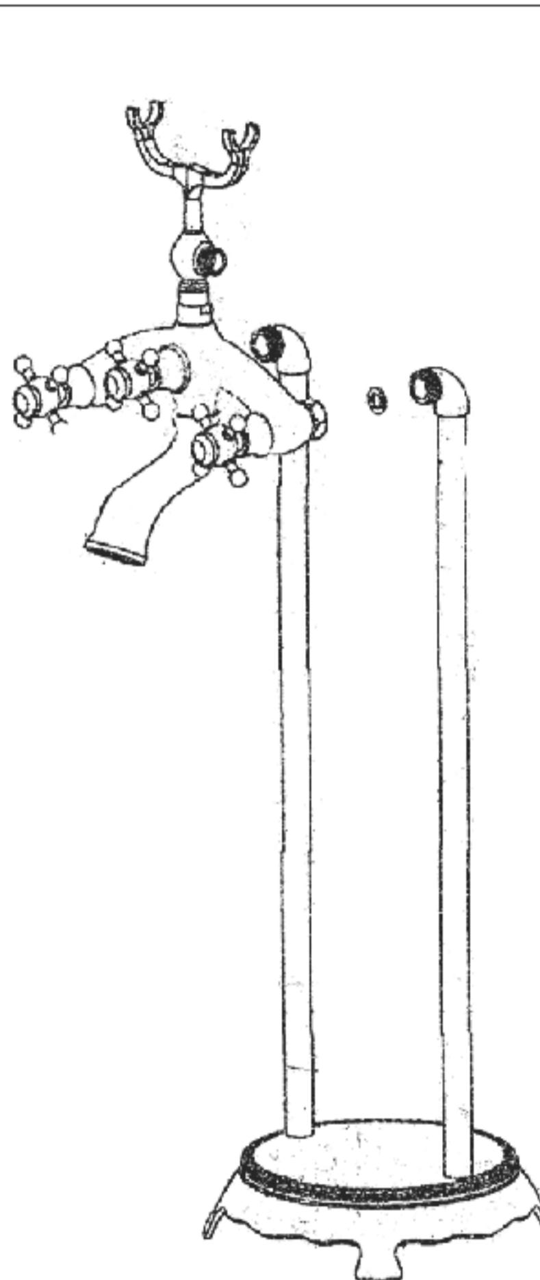
2. Inainte de a monta bateria, curatati tevile cu apa. Pozionati bateria si garniturile dupa care strangeti piulitele de fixare.
