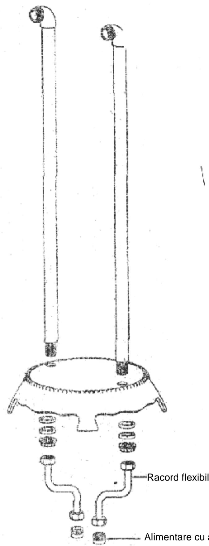
1. Inainte de a monta bateria, curatati tevile, la interior, cu apa. Pozionati si asamblati tevile pe stativ. Montati racordurile de alimentare, in partea stanga apa calda - in partea dreapta apa rece, si racordati la alimentarea cu apa locala.
