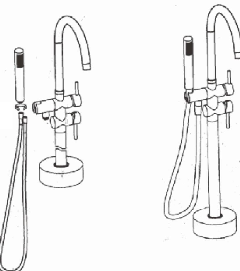
1. Montati furtunele de apa calda si rece (6) si strangeti, atentie nu folositi unelte, acestea se strang doar cu mana.
