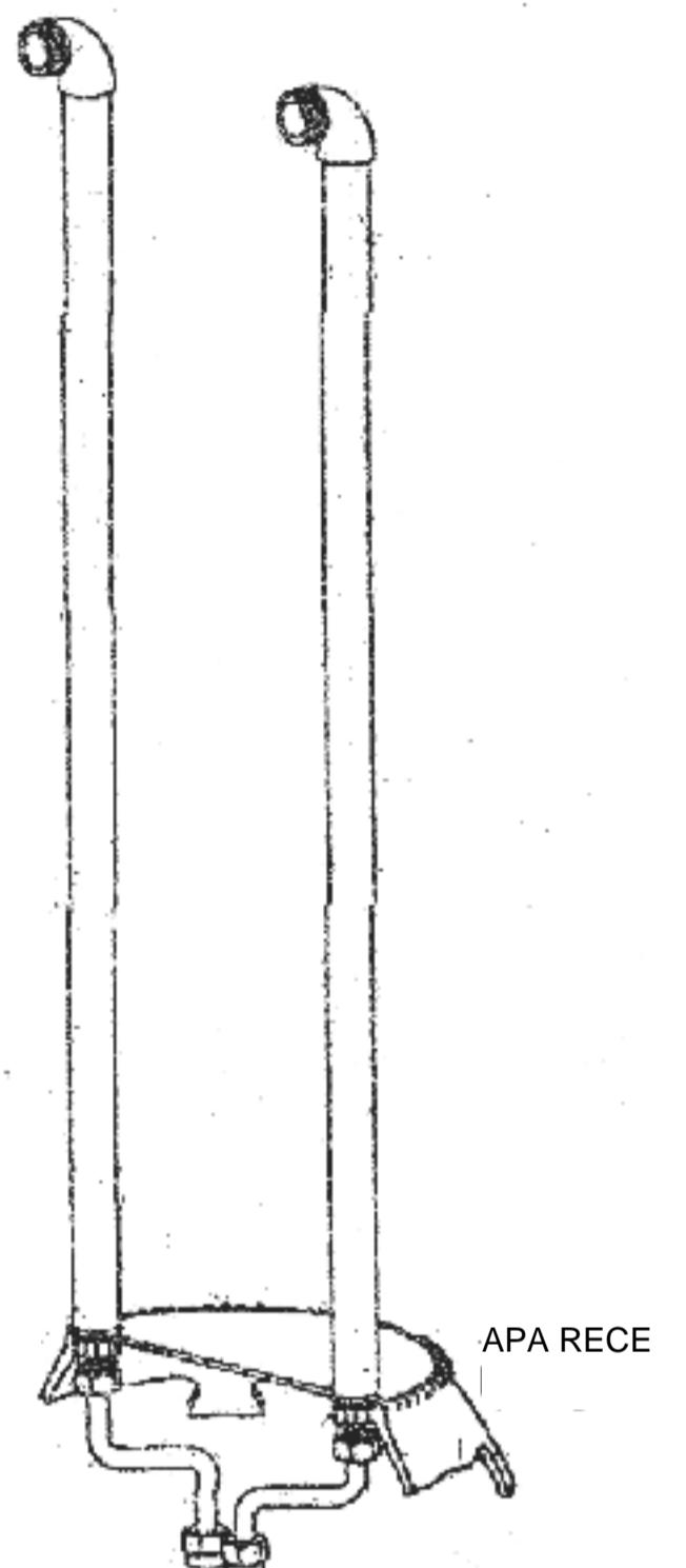
1. Montati furtunele de apa calda si rece (4) si strangeti, atentie nu folositi unelte, acestea se strang doar cu mana.
