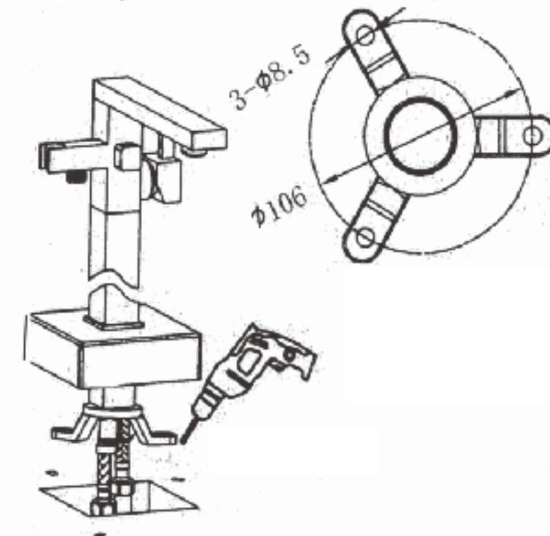
6. Pozitionati si fixati bateria in gaurile forate., cu ajutorul suruburilor cu diblu (8).
