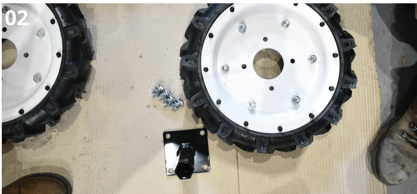
Fig. 3. Fixați roata de transport pe ax folosind șurub, piuliță și șaibă.
