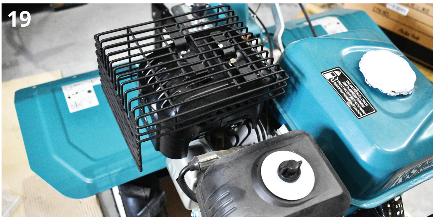
Fig. 19. Așezați grila de protecție pe unitatea de rezonanare și fixați grila cu șuruburi.
