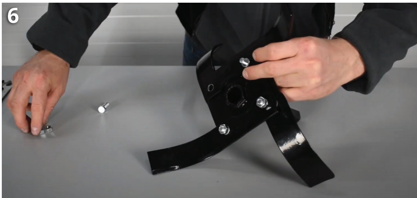
Fig. 7. Conectați secțiunile împreună folosind știfturi de blocare, apoi blocați știfturile de blocare folosind cuie spintecate.
