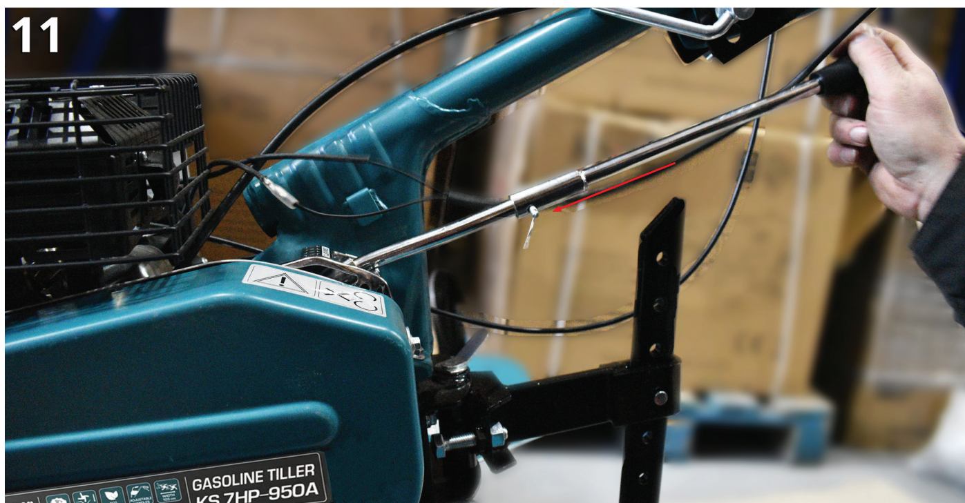
Fig. 11. Fixați maneta schimbătorului folosind un știft de blocare, apoi fixați știftul de blocare folosind un cui spintecat.
