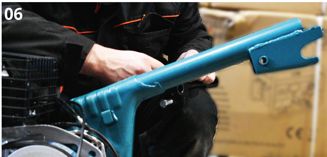
Fig. 7. Blocați poziția mânerului de comandă cu dispozitivul de fixare.
