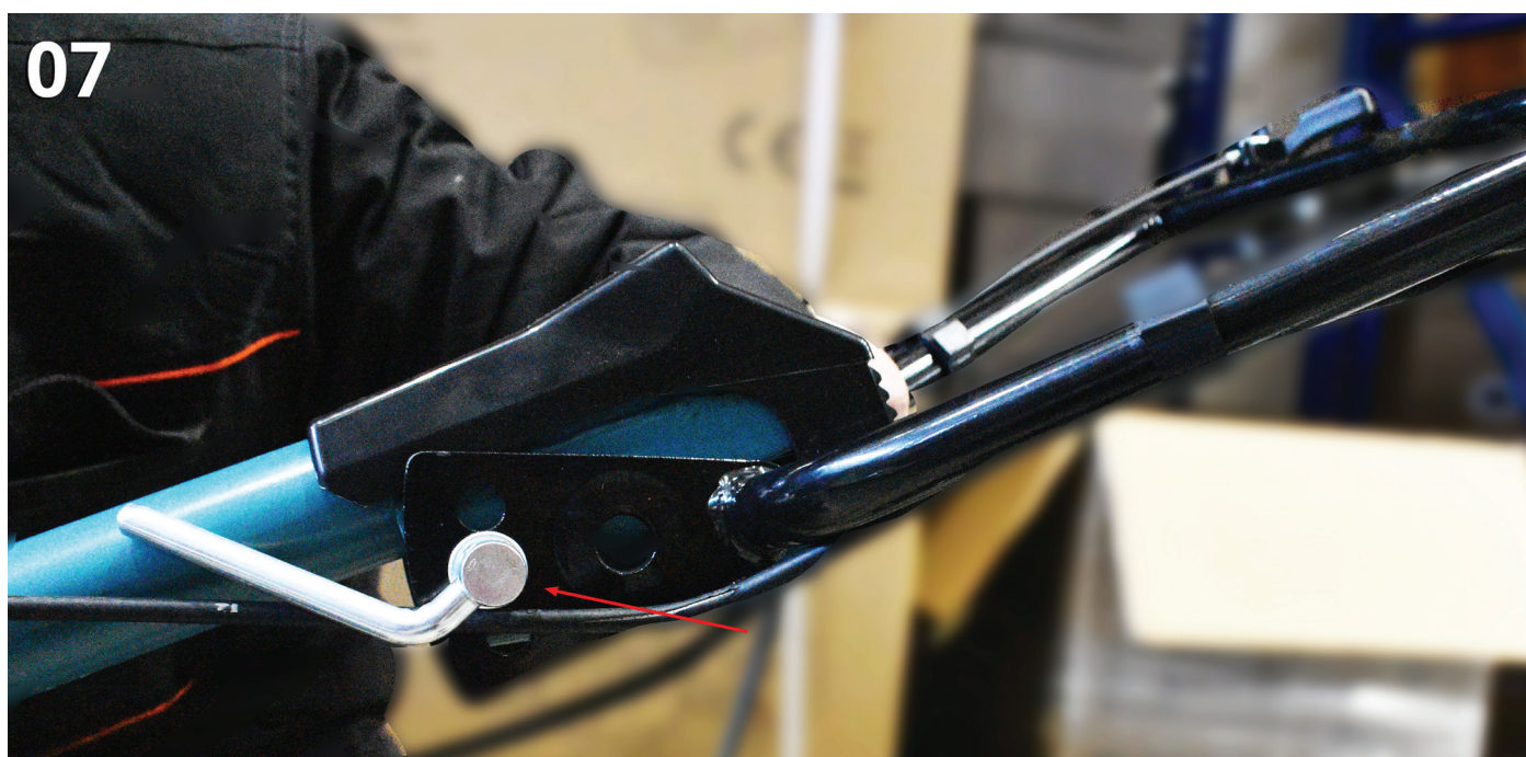
Fig. 7. Blocați poziția mânerului de comandă cu dispozitivul de fixare.
