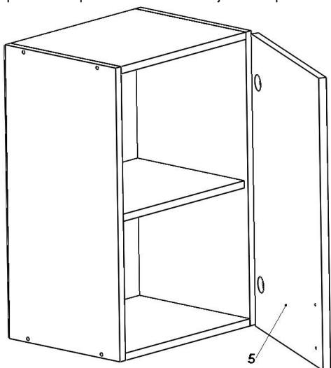
NOTĂ: Usa este pregătită pentru maner. Ea se poate monta pe partea dreaptă sau stângă astăzi cum doriti. Dupa montarea lor pe corp se gaurește cu grijă, prin gaurile existente, și pe poziția dorită (nu toate gaurile) cu ajutorul unui burghiu Ø5.
