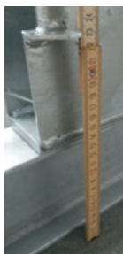
Adâncimea de introducere a montanțului de oțel (cca. 22,5 cm)
