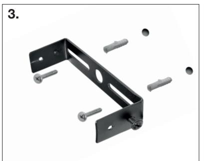
1. Skruva ur fästskruvorna och ta av monteringskonsolen.
