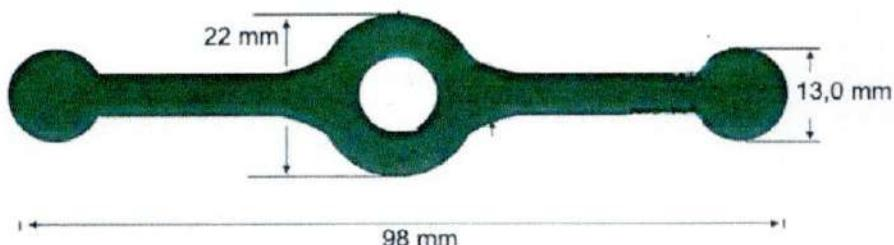
*Figura nr. 16: Benzi DB3 x 100 Diaphragm Wall Waterbar*
