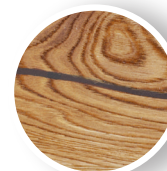
fisuri de capăt și suprafață
