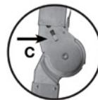
1. **RO** Pentru a debloca balamalele trageți în sus maneta de pe fiecare balama până când clapeta de blocare se afilă în poziție deblocată.
