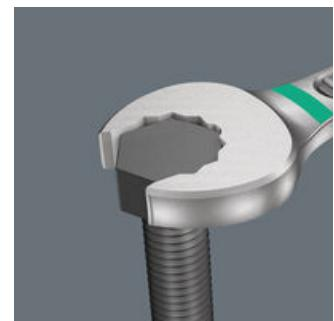
Der Ringmaulschlüssel Joker 6003 mit seiner besonderen Maulgeometrie - eine um 7,5° geschwenkte Maulseite und die Doppelsechskantgeometrie - verdoppelt die Ansetzmöglichkeiten bei wiederholter 180°-Drehung des Schlüssels um die Längsachse. Muttern bzw. Schraubenköpfe können alle 15° "gepackt" werden. Den jeweiligen Ansetzpunkt findet der Joker 6003 nach jedem Wenden sozusagen von selbst.
