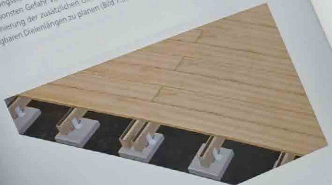
Bild 7.3 Ausführung von Längsstößen zwischen zwei Auflagern
